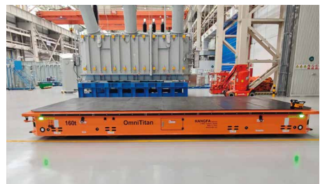
OmniTitan-重载联动全向运输车(160t)
