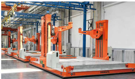
OmniRhino-转向架自动生产线(13t)
